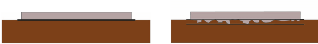
Figur 9 Figuren till vänster visar hur ett interface ser ut i PLAXIS medan figuren till höger illustreras vad de tilldelade egenskaperna skulle kunna representera.
